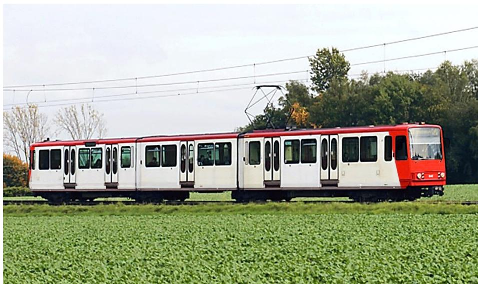
Das Einfügen eines 10 Meter langen Mittelteils erhöht die Kapazität des B-Wagens um 37% = 28 Sitz- und 80 Stehplätze. Offiziell heißt der 38 Meter lange Achtachser B80C/8 – die *VS-NF* nennt ihn aber C-Wagen, weil dieser einfachere Begriff anderweitig nicht verwendet wird.
