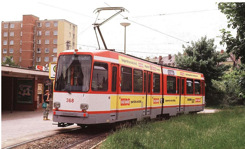
*1977 bekam die VAG Nürnberg zwölf N6-Stadtbahnwagen. Den Wagenkasten baute Düwag und MAN stellte sie in Nürnberg fertig. Sie waren kürzer und schmaler als die B-Wagen und boten nur 36 Sitzplätze. Weil sie keine Kupplungen für Doppeltraktion hatten, setzte die VAG sie nur auf den Linien mit geringer Nachfrage ein. Das Foto schoss Lars Brüggemann am 22.5.86 am Gibitzenhof.*
